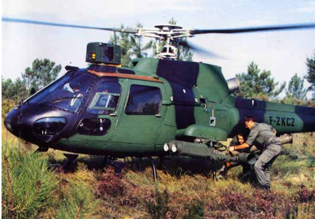
Laddning av HELITOW-systemet för provskjutning från danska arméns helikoptrar.
