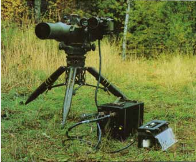
Laserskjutsimulator för pansarvärnsroboten TOW.
